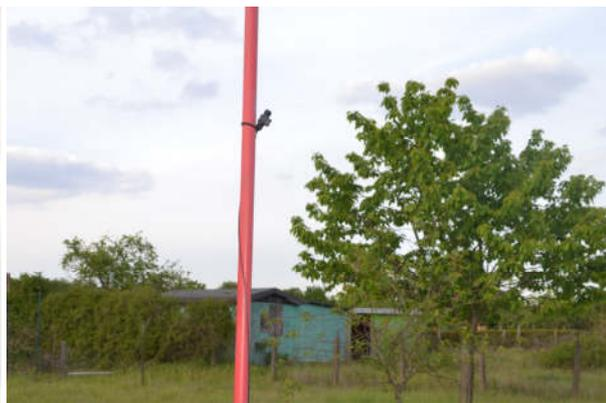
**Bild 14: Horchbox-Mikrofon an Fahnenmast**
